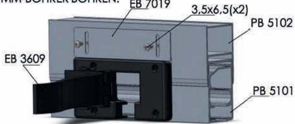
10. DIE PANELEE, VON DEM ERSTEN BIS ZUM LETZTEN, MIT IMBUSSSCHRAUBEN IN DEN ROLLEN REGULIEREN (Abb. 10.1.1 und 10.2)
