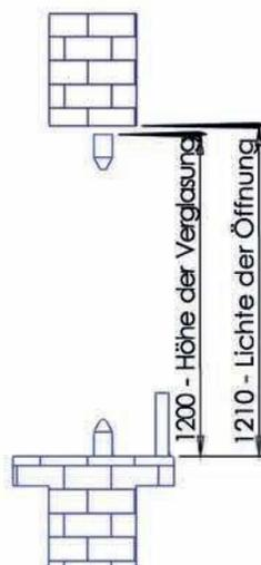
Für die Führung ohne Teleskopprofil soll in der Höhe das min. Montagespiel 10 mm betragen. Bei Profilen mit einem Teleskop soll das min. Montagespiel 5 mm betragen.
