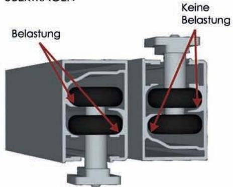
2. DIE OBERE FÜHRUNG WIRD AN DIE DECKE MONTIERT. FÜR DIE BEFESTIGUNG WERDEN WERKSEITIG VORBEREITETE ÖFFNUNGEN SOWIE ENTSPRECHENDE SCHAFTSCHRAUBEN UND BOLZEN VERWENDET.
