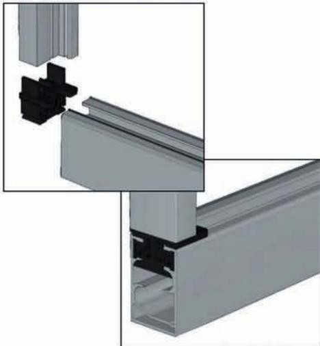
DIE FÜHRUNGEN KÖNNEN MITEINANDER MIT EINEM VERBINDUNGSSTÜCK (GERADE ODER WINKEL) VERBUNDEN WERDEN. DAS VERBINDUNGSSTÜCK WIRD MIT DEN FÜHRUNGEN MITHILFE VON BOLZEN VERSCHRAUBT.
