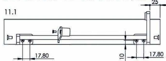
ÖFFNUNG  $\varnothing$  3,5 IN DER FÜHRUNG FÜR DIE SCHAFTSCHRAUBE 4,2X13 GEBOHRT
