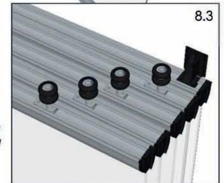
NACH DEM EINSCHIEBEN DIE PANELEE GEÖFFNET LASSEN (Abb. 8.2). DIE VERTEILUNG DER ROLLEN WIE AUF DER ABBILDUNG 8.3 BEDEUTET DIE KORREKTE ANORDNUNG DER PANELEE
